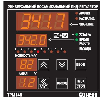
Рис. 1. Передняя панель универсального восьмиканального ПИД-регулятора ТРМ148
