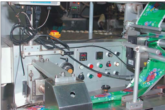
Фото 2. Упаковочное оборудование на основе термопреобразователей ОВЕН дТПЛ 124-00.Л/1,5 и ПИД-регулятора с универсальным входом и интерфейсом ОВЕН ТРМ101
