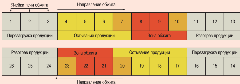
Рис. 4. Схема обжиговой печи и процесса обжига
