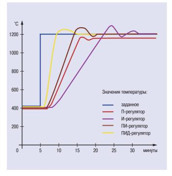
них – двухпозиционном (включено-выключено) – мы уже упомянули. Второй, более совершенный, связанный с непрерывным управлением, получил наименование пропорционально-интегрально-дифференциального (ПИД) закона.
