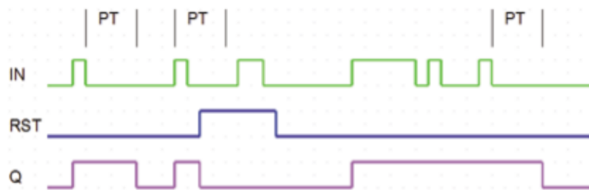
Рис. 15.37. Трассировка работы ФБ TOF_1
