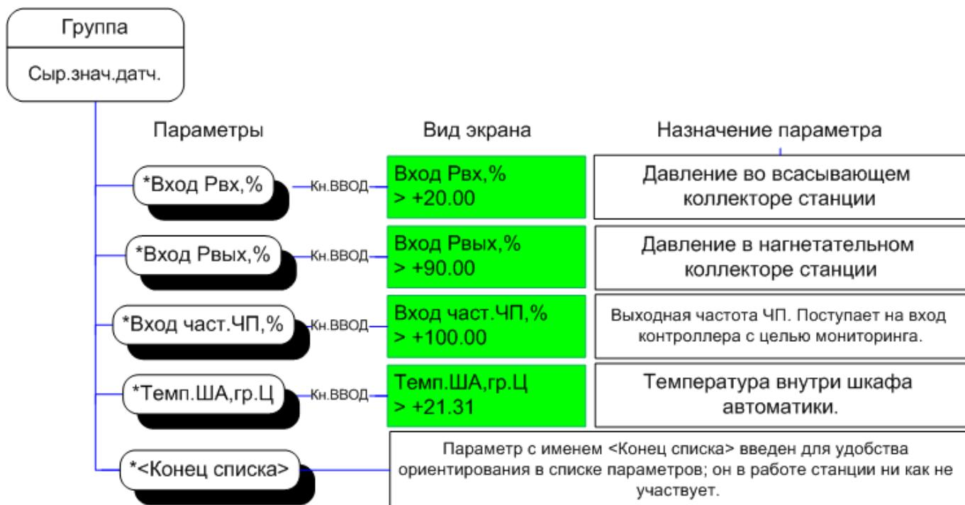
Три первых параметра относятся к датчикам, имеющим токовый выход. Значение внутренней переменной для данного типа измеряется в процентах, т. к. диапазон измерения датчика давления задается оператором, и разработчику программного обеспечения не известен.
