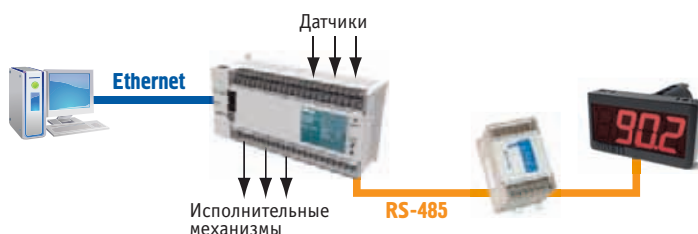
Рис. 3. Применение СМИ2 в простых шкафах автоматики
