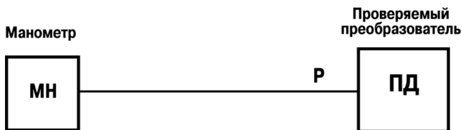
Схема А.6 (гидравлическая) – подключение для поверки преобразователя избыточного давления и разности давлений при использовании грузопоршневого манометра, МН – грузопоршневой манометр (например, МП-2,5, МП-6, МП-60, МП-600, МП-2500)
