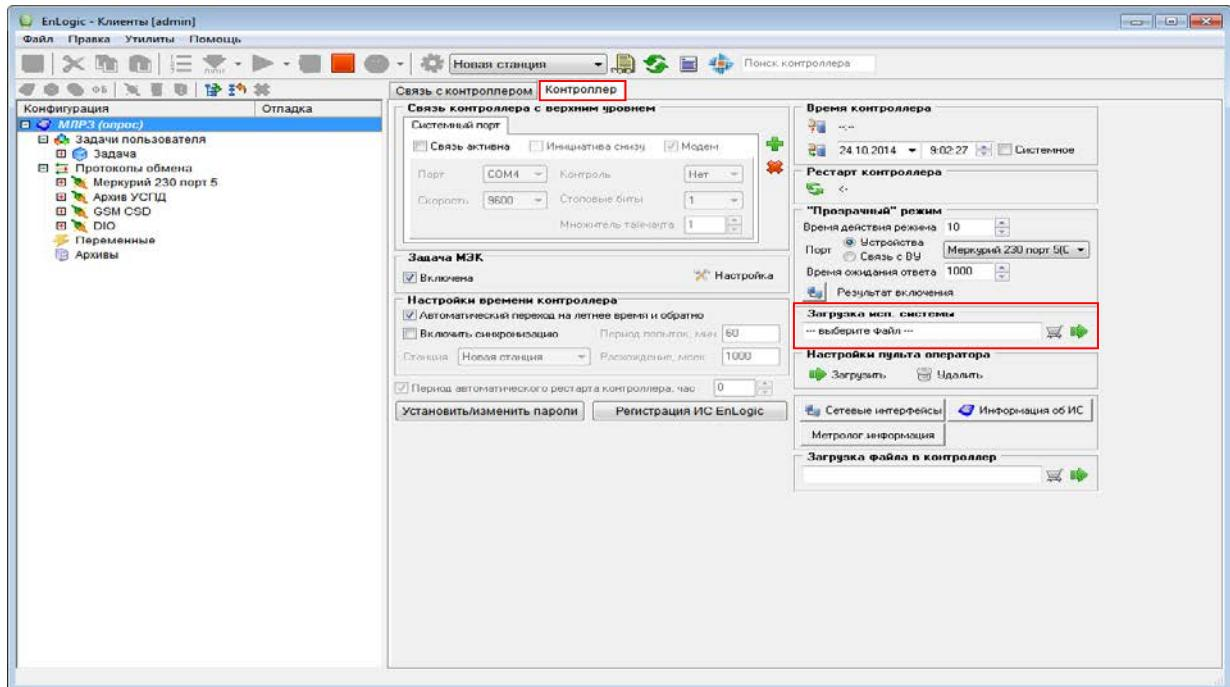
По окончании процесса загрузки ИС ПЛК323-ТЛ выполнит команду *рестарт*. Увидеть информацию об исполнительной системе можно, перейдя на вкладку «Контроллер» и нажав кнопку «Информация об ИС»:
