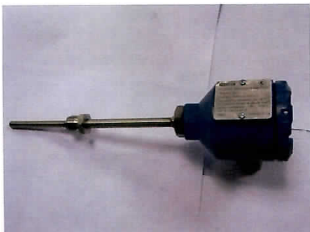
Рис.1 - Общий вид термopеобразователей сопротивления с клеммными головками модели XX5
