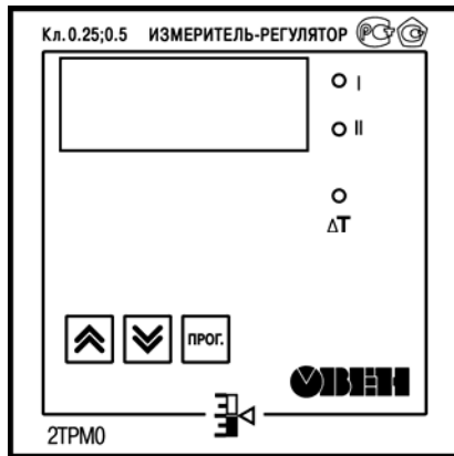
Рисунок 3.4 – Лицевая панель прибора
