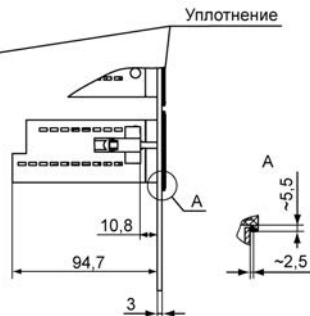
Рисунок А.7 - Прибор в корпусе Щ2, установленный в щит толщиной 3 мм
