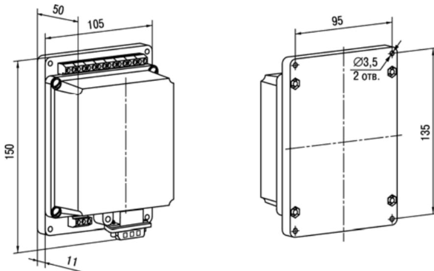
Рисунок А.1 - Габаритный чертеж адаптера AC2
