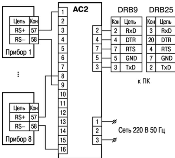
Рисунок Б.1 – Подключение приборов ТРМ32-Щ4, ТРМ33-Щ4, УКТ38-Щ4
