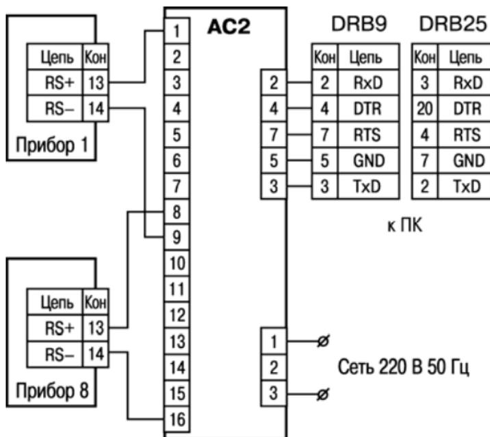
Рисунок Б.2 – Подключение приборов МПР51-Щ4
