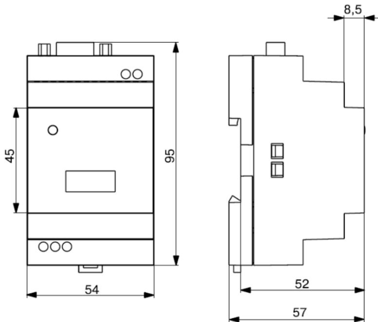
Рисунок А.1 – Габаритный чертеж прибора
