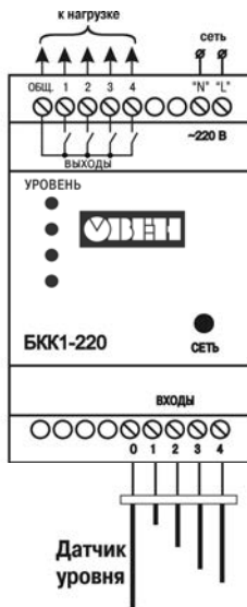
Рисунок Б.2 – Схема подключения БКК1-220
