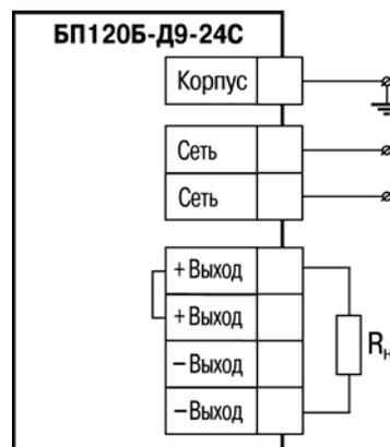
Рисунок 5.1 – Типовая схема подключения блока
