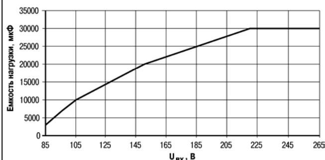
Рисунок 2.1 – Зависимость максимальной емкости нагрузки от входного напряжения
