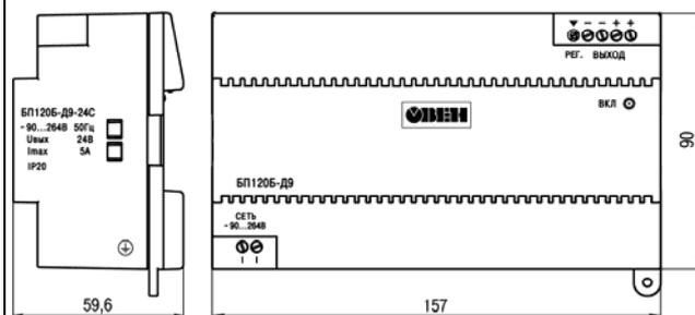
Рисунок 3.1 – Габаритные размеры блока
