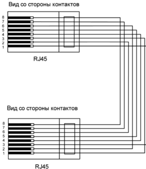
Рисунок Б.1 – Схема кабеля Ethernet Crossover
