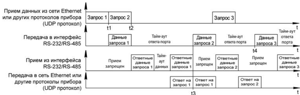
Рисунок 4.6 – Диаграмма работы прибора в режиме «запрос – ответ»
