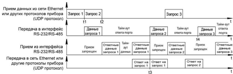
Рисунок 4.7 – Диаграмма работы прибора в режиме «запрос – ответ»
