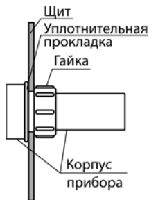
Рисунок 5.1 – Монтаж прибора в щит
