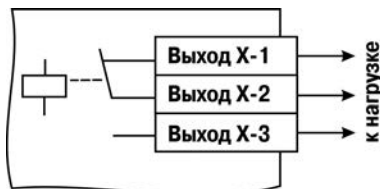
Рисунок Б.2 – Схема подключения к выходному элементу типа Р
