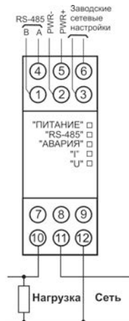
Рисунок Б.1 – Подключение прибора к однофазной сети
