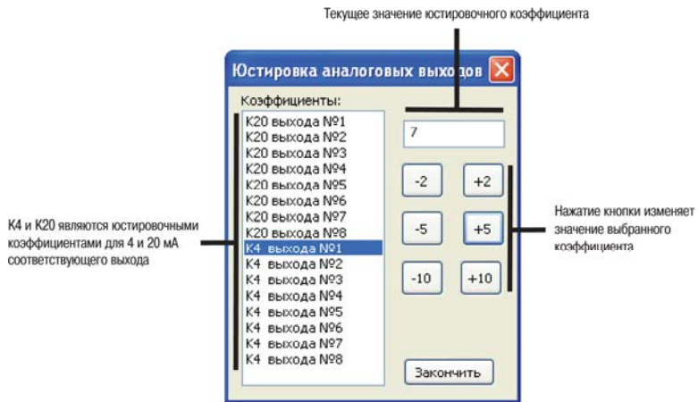
Рисунок Д.2 - Юстировка ВЭ
