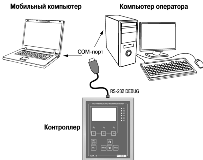
Рисунок 4.1 – Вариант подключения к ПК для программирования контроллера через порт RS-232 DBGU
