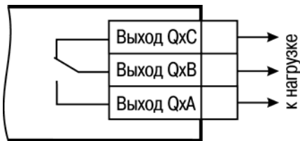
Рисунок 6.1 - Схема подключения нагрузки к ВЭ типа Р
