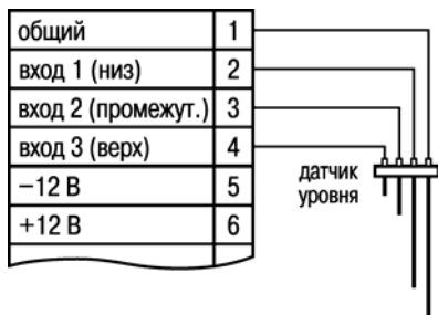
Рисунок Б.2 – Схема подключения кондуктометрических датчиков уровня
