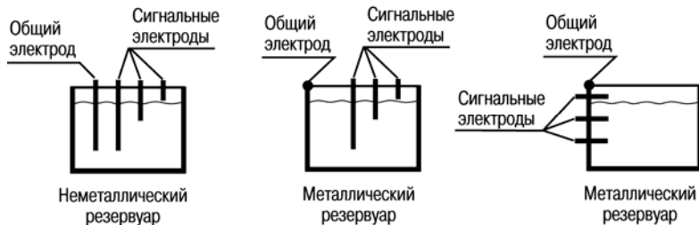
Рисунок 3.5 – Примеры установки кондуктометрических зондов
