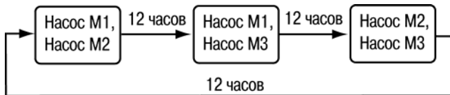
Рисунок В.10 – Порядок работы насосов в режиме «два из трех»
