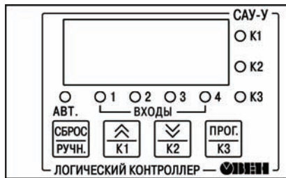
Рисунок 3.10 – Внешний вид лицевой панели прибора для корпуса и щитового (Щ1) крепления
