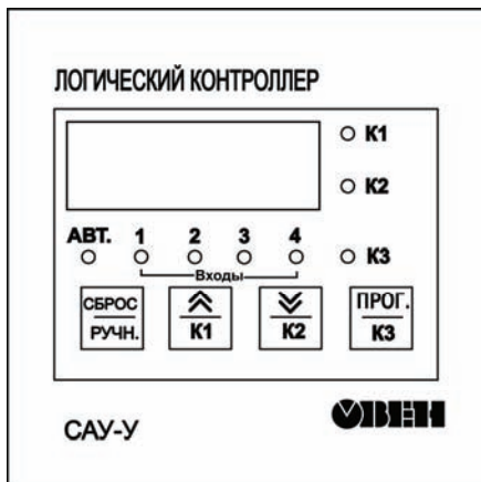
Рисунок 3.8 – Внешний вид лицевой панели прибора для корпуса настенного (Н) крепления
