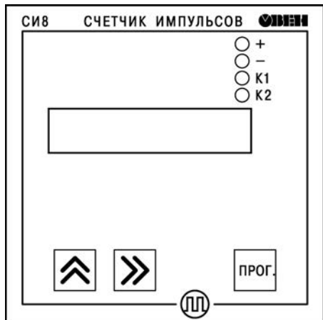
Рисунок 3.6 – Внешний вид лицевой панели приборов для корпусов настенного (Н) и щитового (Щ1) креплений
