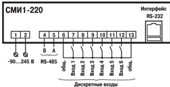
Рис. Б.1. Схема подключения питания, дискретных входов, интерфейсов RS-232 и RS-485 панели СМІ1-220
