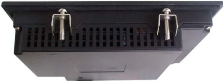
Рисунок 4.1 - Установка крепежных зажимов
