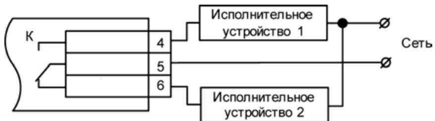
**Рисунок Б.2 – Схема подключения нагрузки к ВУ типа Р**
