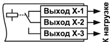
Рисунок Б.2 – Схема подключения нагрузки к ВУ типа Р
