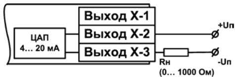
Рисунок Б.7 – Схема подключения нагрузки к ВУ типа И
