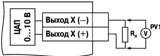
Рисунок Б.14 – Схема подключения нагрузки к ВУ типа У. R_n > 2 \text{ кОм}
