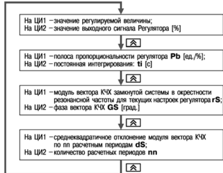
Рисунок 12.3 – Схема переключения индикации в режиме Автонастройки
