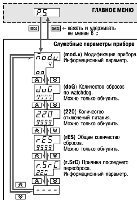
Рисунок 11.18 – Схема доступа к служебным параметрам прибора
