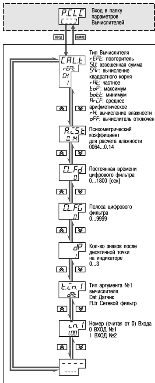
Рисунок 11.11 – Схема задания параметров Вычислителей
