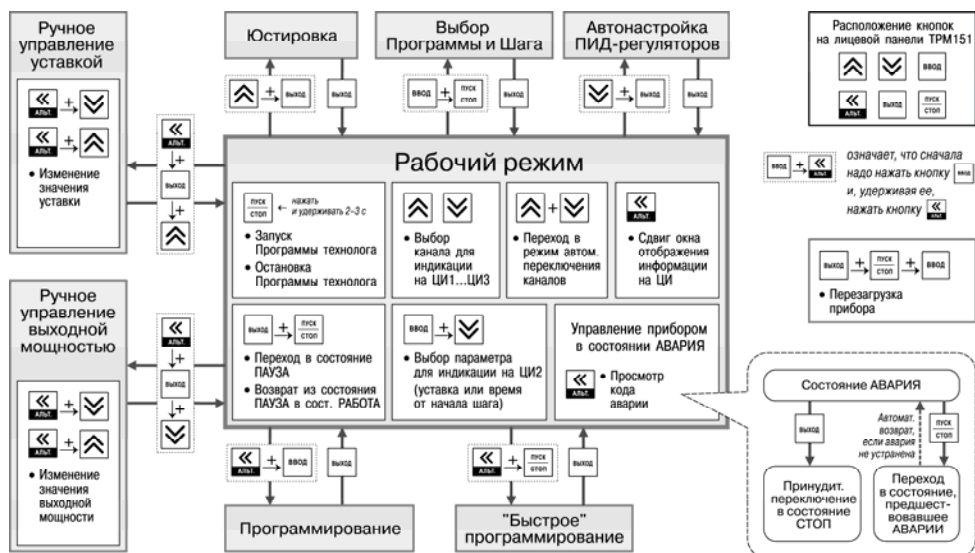
Рисунок 5.3 – Схема переключения режимов прибора
