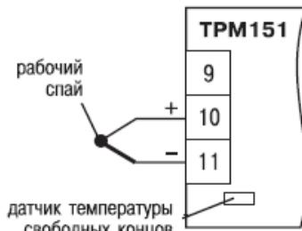
Рисунок Г.2 - Подключение термопары
