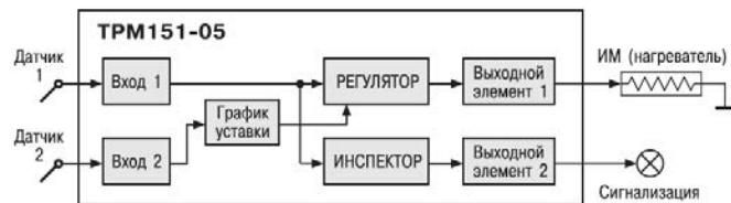
**TPM 151-05.** Одоканальное пошаговое регулирование, при этом Уставка Регулятора может быть скорректирована по определенной функции от значения, измеренного на Входе 2. Имеется блок Инспектора, соединенный с ВЭ2.
