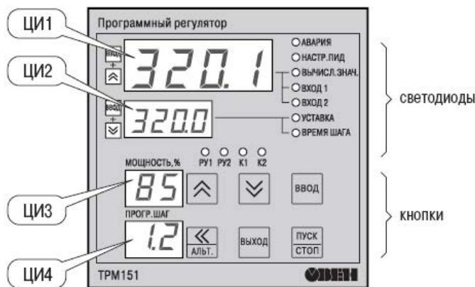
Рисунок 5.1 - Лицевая панель прибора
