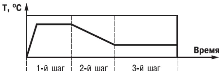
Рисунок 3.3 - Пример Программы технолога для TPM151-04
