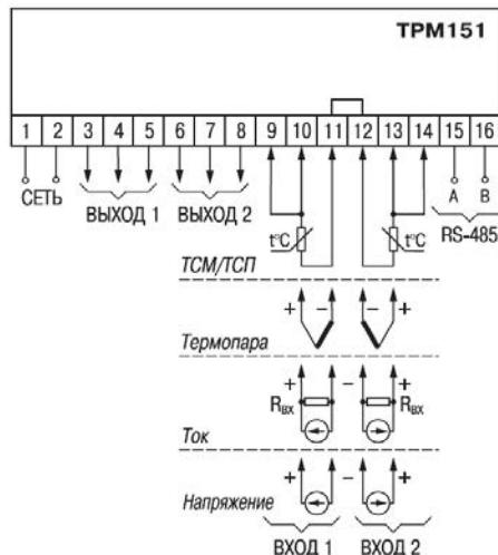
Рисунок Б.1 - Общая схема подключения TPM151-04
