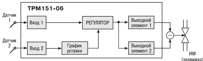
**TPM151-06.** Одоканальное пошаговое регулирование задвижкой без датчика положения. При этом Уставка Регулятора может быть скорректирована по определенной функции от значения, измеренного на Входе 2.
