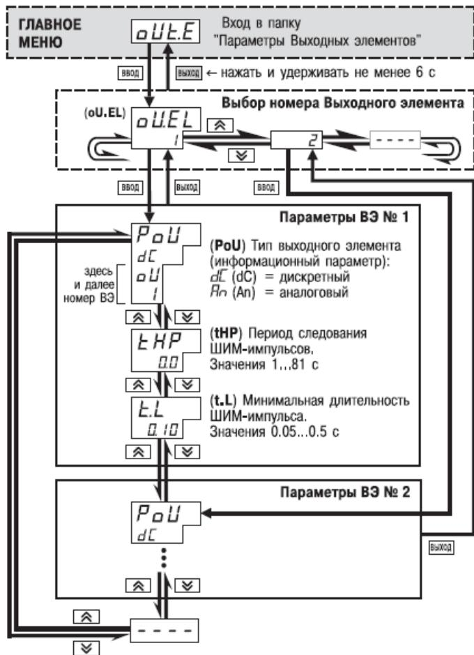
Рисунок 11.15 - Схема задания параметров Выходных элементов
