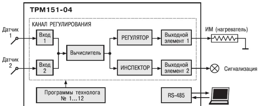
Рисунок 3.1 - Структурная схема TPM151-04
