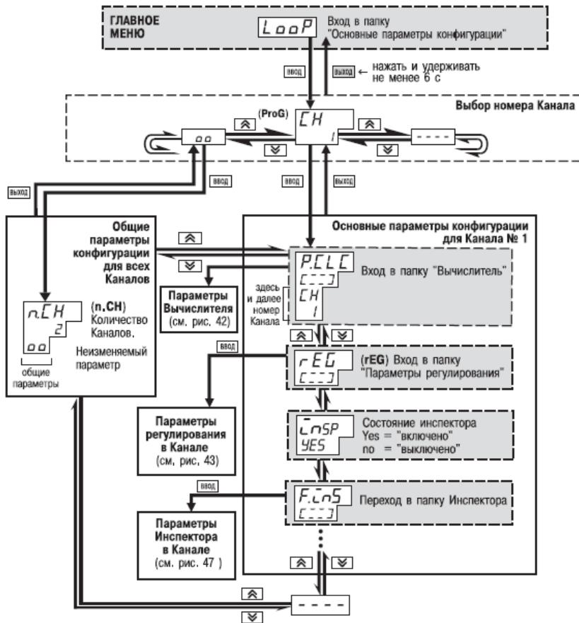
Рисунок 11.10 - Схема задания основных параметров конфигурации
