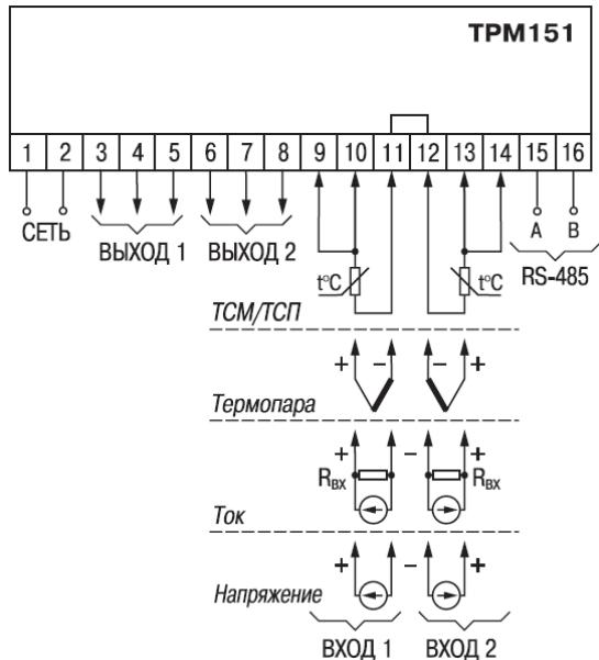
Рисунок Б.1 - Общая схема подключения TPM151-05
