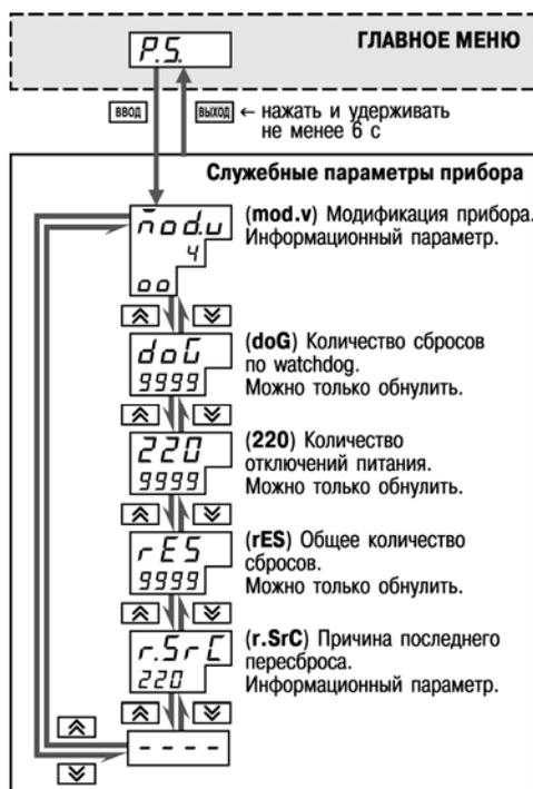
Рисунок 11.18 – Схема доступа к службным параметрам прибора
