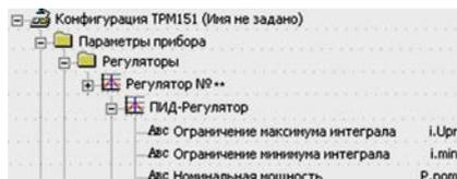
Настройку ПИД-регулятора рекомендуется выполнять в автоматическом режиме (см. п. 12.6). При настройке вручную Вы можете определить приблизительные значения параметров регулятора по Приложению Ж.2.
