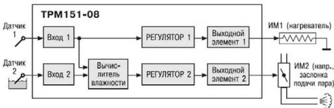
**ТРМ 151-08.** Одновременное пошаговое регулирование температуры и влажности. Вычисление влажности производится психрометрическим методом по температуре «сухого» и «влажного» термометров.
