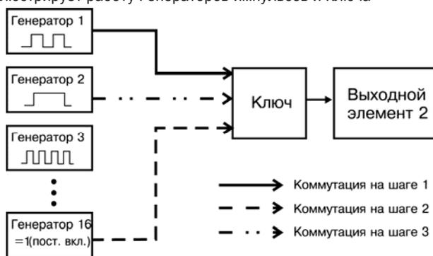
Рисунок 3.8 – Работа Генераторов импульсов и Ключа
