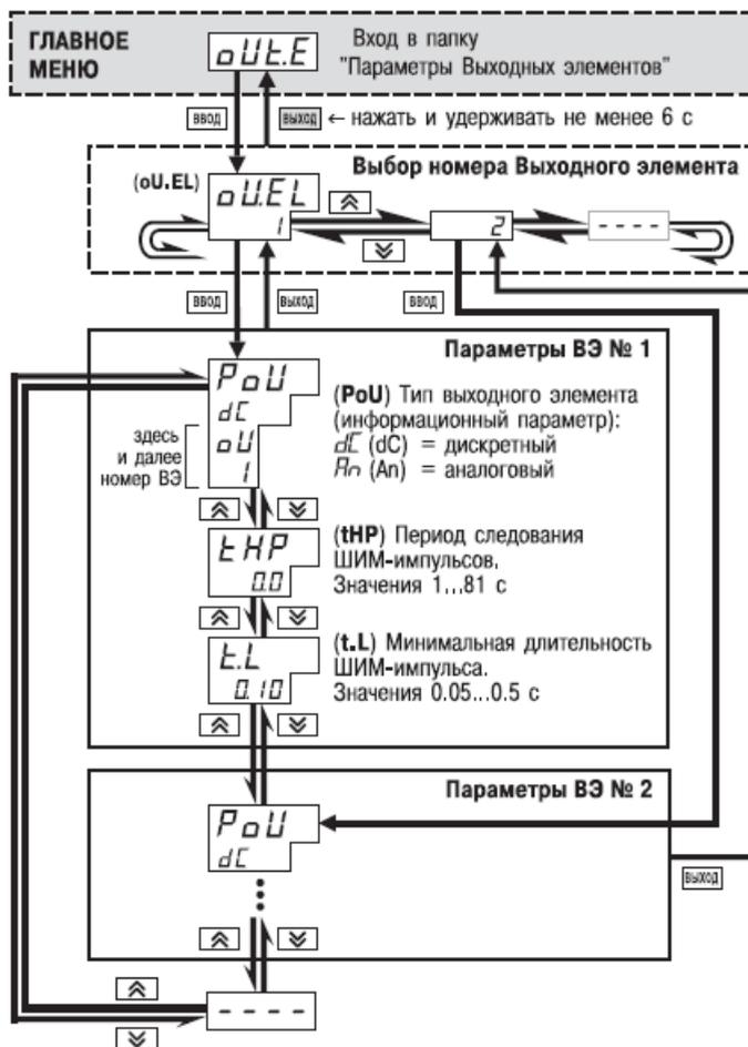
Рисунок 11.14 – Схема задания параметров Выходных элементов
