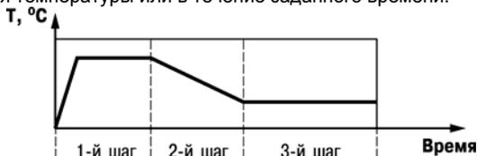
Рисунок 3.2 – Пример Программы технолога для ТРМ151-09
