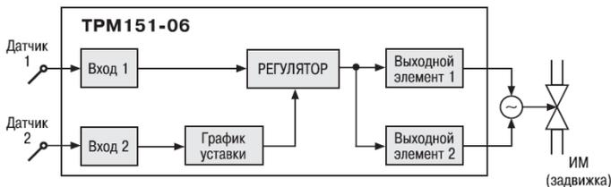
**ТРМ151-06.** Одноканальное пошаговое регулирование задвижкой без датчика положения. При этом Уставка Регулятора может быть скорректирована по определенной функции от значения, измеренного на Входе 2.
