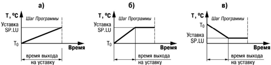
$$\text{Скорость выхода на уставку LF.LU} = \frac{\text{Уставка SP.LU} - T_0}{\text{время выхода на уставку}} \frac{[\text{ед. изм.}]}{[\text{мин}]}$$
