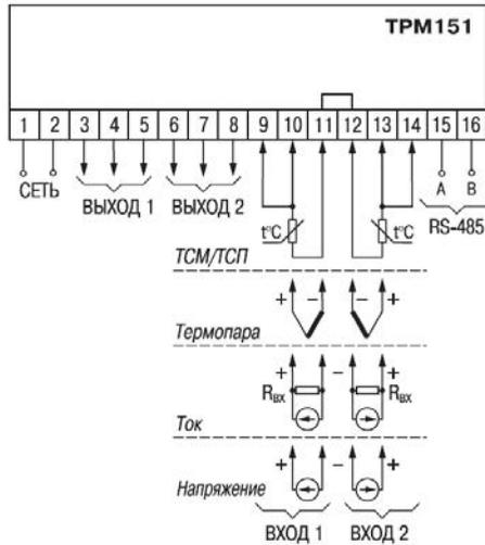
Рисунок Б.1 - Общая схема подключения ТРМ151-04
