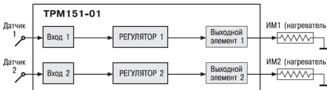
**TPM 151-01.** 2 Канала пошагового регулирования по измеренной величине, каждый Канал подключен к своему Выходному элементу. Регулятор может работать в режимах ПИД и ON/OFF.
