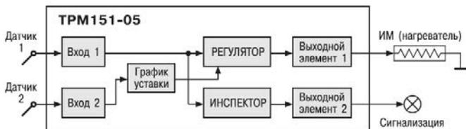
**ТРМ 151-05.** Одноканальное пошаговое регулирование, при этом Уставка Регулятора может быть скорректирована по определенной функции от значения, измеренного на Входе 2. Имеется блок Инспектора, соединенный с ВЭ2.
