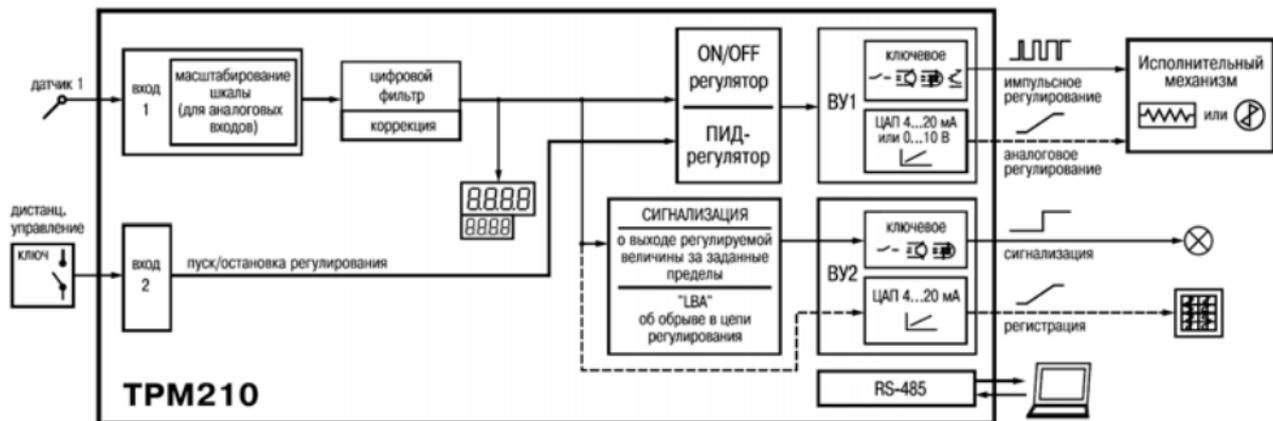
**Рисунок 3.2 – Структурная схема TPM 210**
