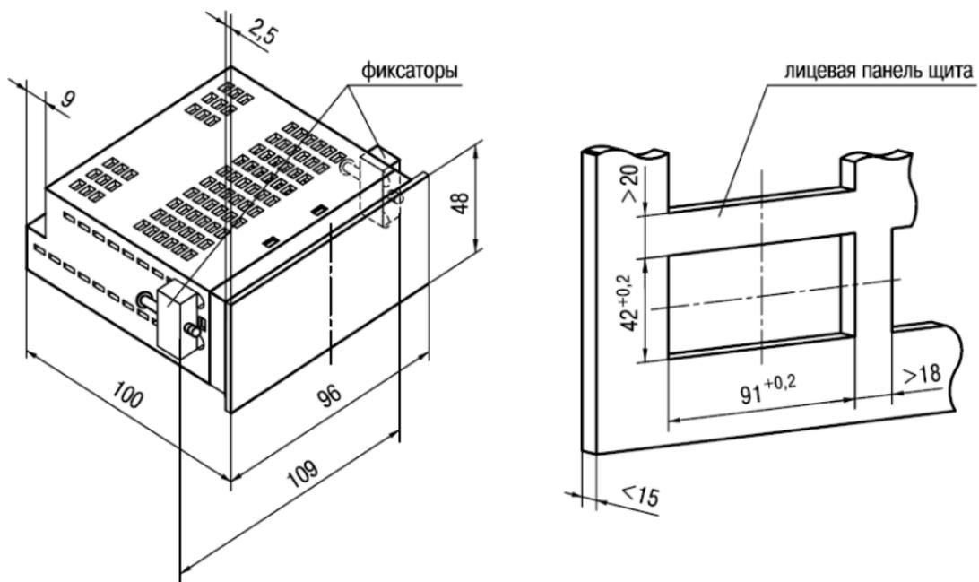
**Рисунок А.4 – Прибор щитового крепления Щ2**
