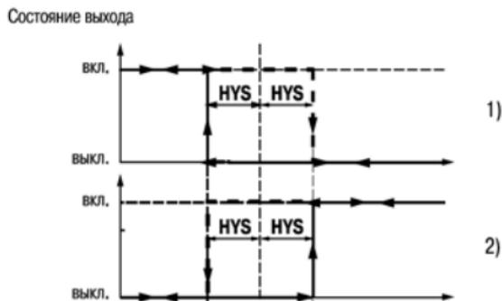
**Рисунок 3.7 – Диаграммы срабатывания прибора по типам логики:
