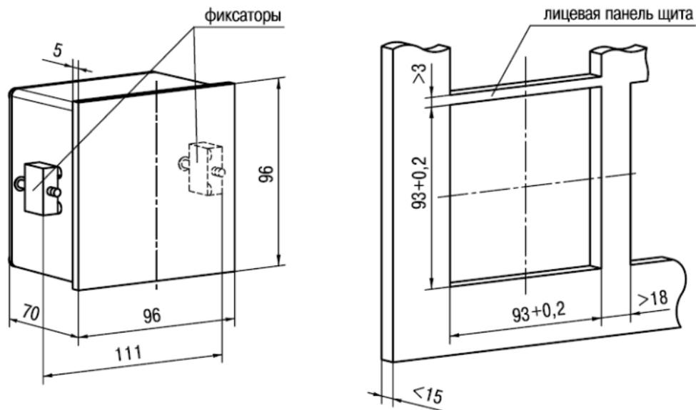
**Рисунок А.3 – Прибор щитового крепления Щ1**
