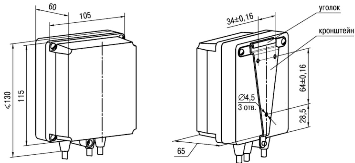
Рисунок А.1 – Прибор настенного крепления Н
