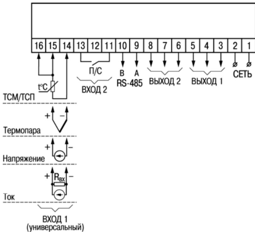
**Рисунок Б.2 – Общая схема подключения TRM210-H2**
