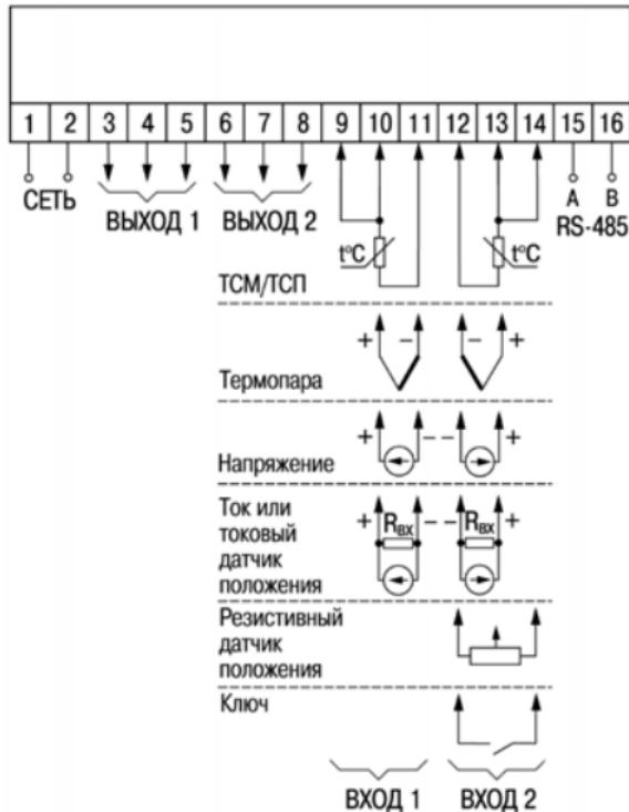
Рисунок Б.1 – Общая схема подключения TPM212-Н, -Щ и -Щ2
