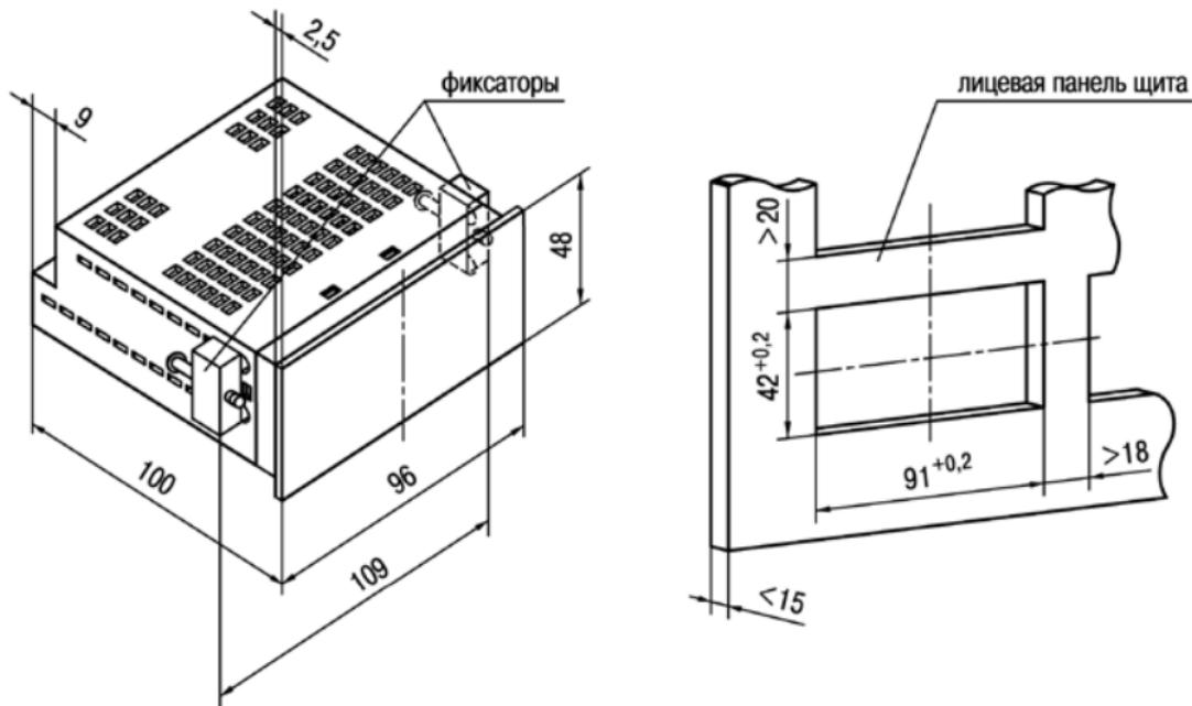
Рисунок А.4 – Прибор щитового крепления Щ2
