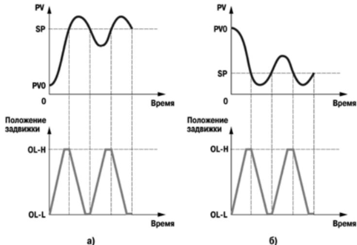
Рисунок 7.1 – Колебания системы в режиме автонастройки прибора
