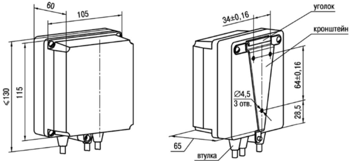
Рисунок А.1 – Прибор настенного крепления Н
