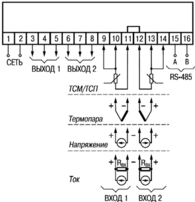
Рисунок В.1 – Общая схема подключения TPM202-Н, -Щ1 и -Щ2
