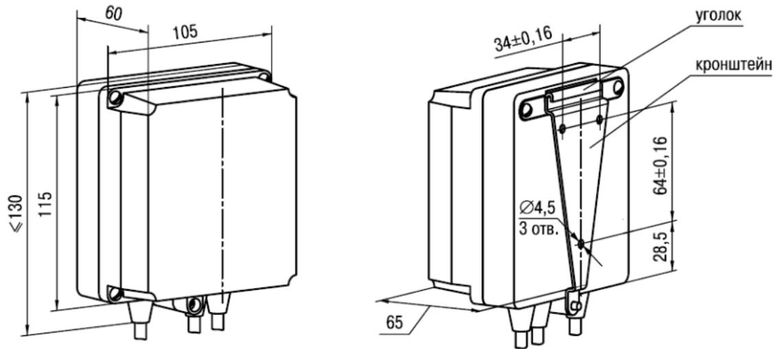
Рисунок А.1 – Прибор настенного крепления Н
