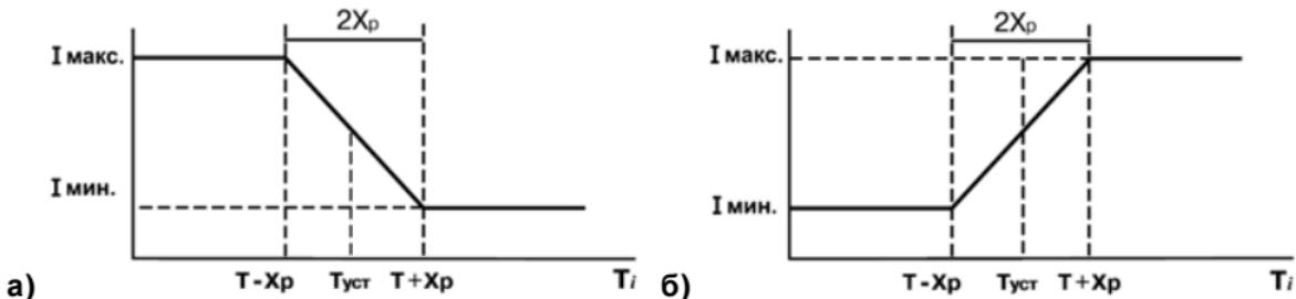
**Рисунок 3.9 (а – обратное управление, б – прямое управление)**
