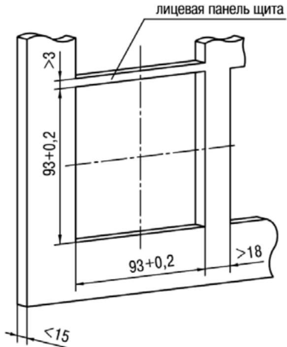
Рисунок А.3 – Прибор щитового крепления щ1
