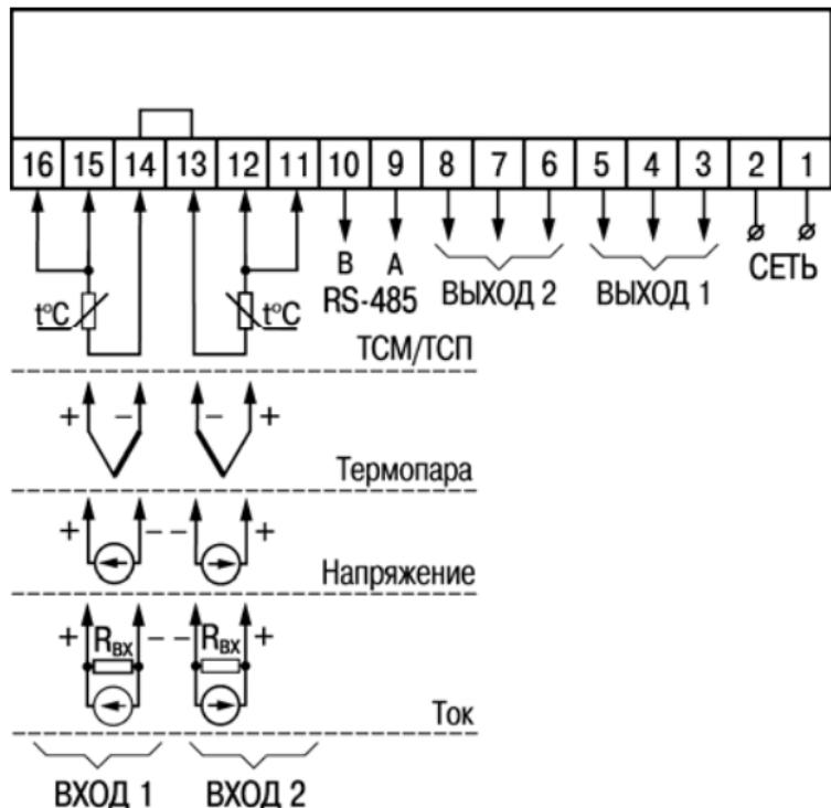
Рисунок В.2 – Общая схема подключения TPM202-H2
