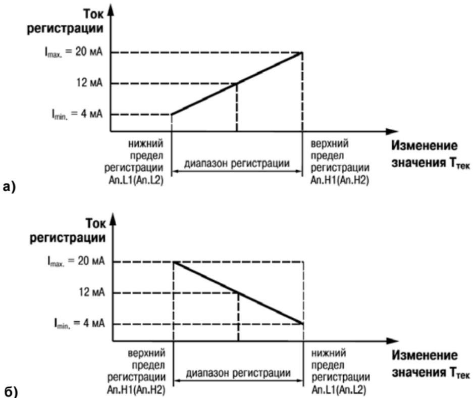
Рисунок 3.10 (а –  $An.L < An.H$ , б –  $An.L > An.H$ )
