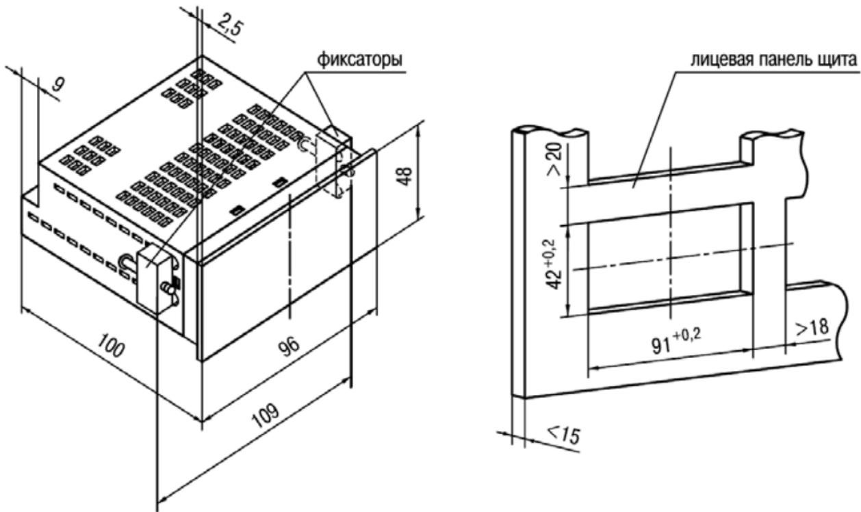
Рисунок А.4 – Прибор щитового крепления Щ2
