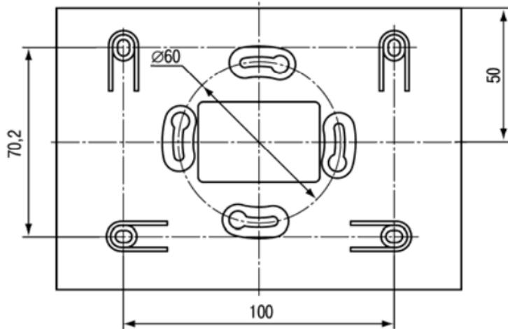
**Рисунок А.2 - Прибор настенного крепления Н2**
