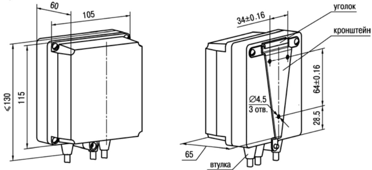
Рисунок А.1 – Прибор настенного крепления Н
