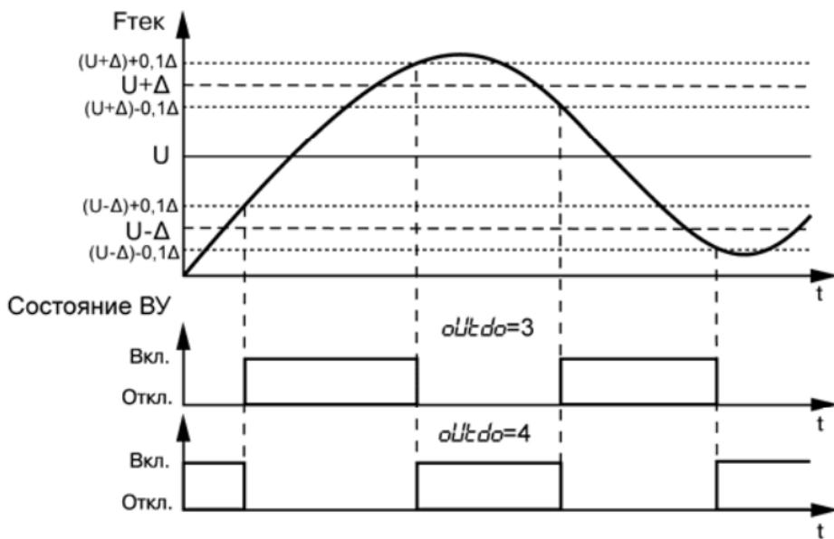
**Рисунок 4.2 – П- и У-образная типы логики при работе ВУ в качестве компаратора**
