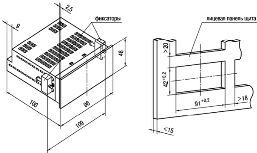
Рисунок А.2 – Прибор щитового крепления Щ2
