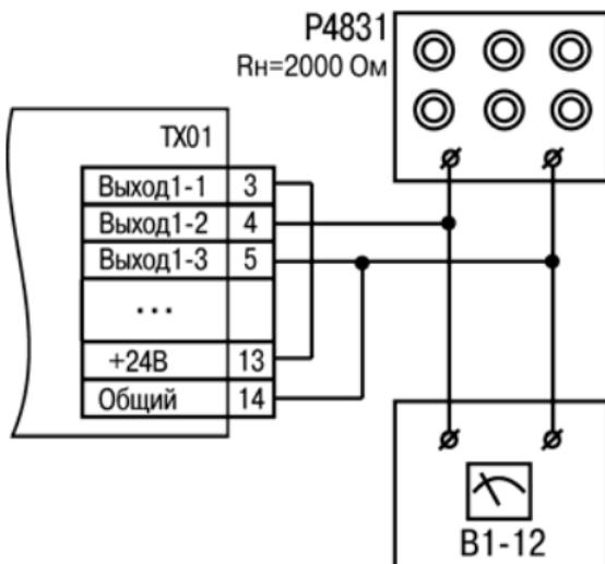
**Рисунок Г.1 – Юстировка значений выходного напряжения**
