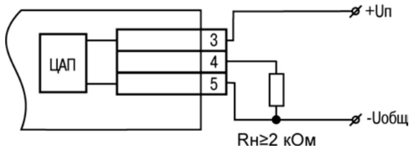
Рисунок Б.8 – Пример подключения ВУ типа У
