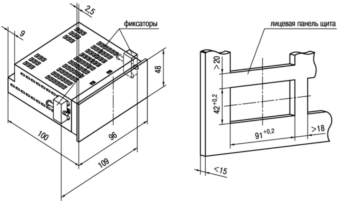
Рисунок А.3 – Прибор щитового крепления Щ2
