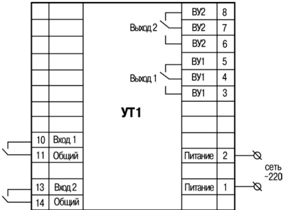
Рисунок Б.2 – Схема подключения прибора в DIN-реевочном исполнении корпуса
