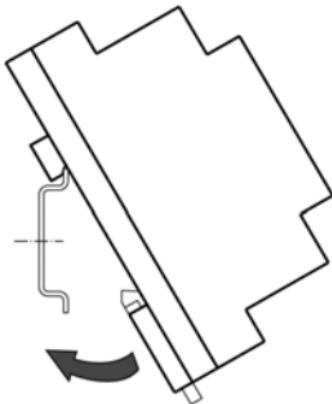
**Рисунок 8.3 – Монтаж прибора с креплением на DIN-рейку**
