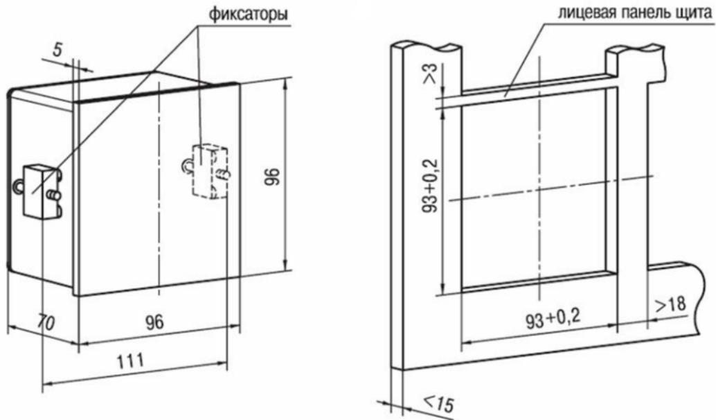
**Рисунок А.2 – Прибор щитового крепления Щ1**
