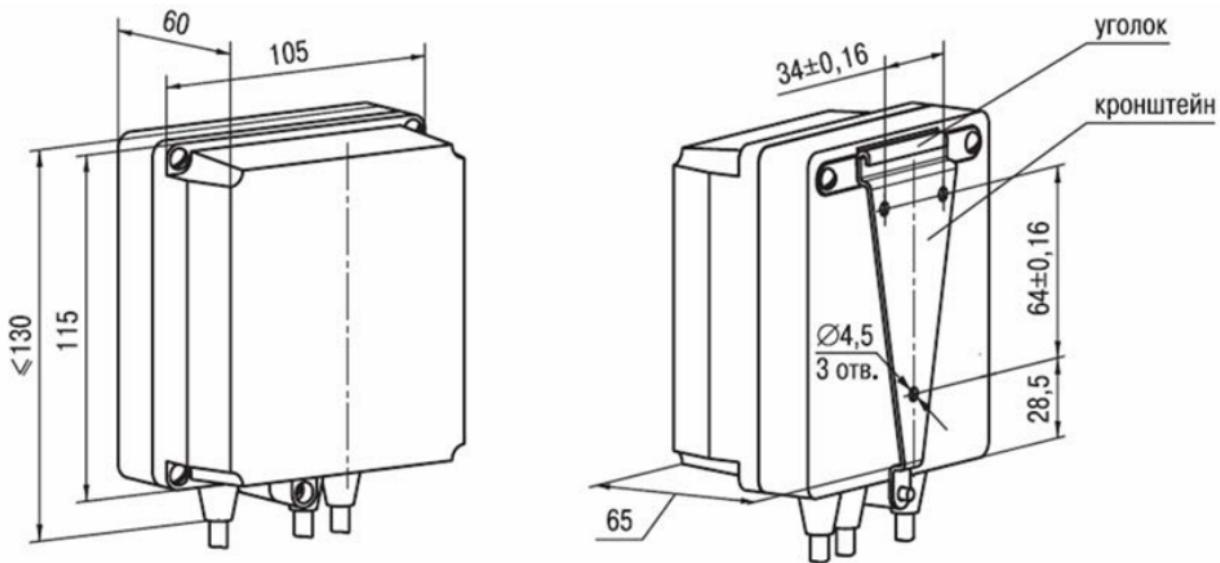
Рисунок А.1 – Прибор настенного крепления
