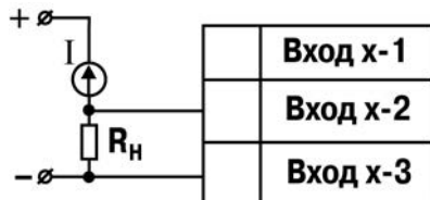
Рисунок Б.9 – Схема подключения термоэлектрического преобразователя
