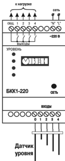
Рис. А.2. Схема подключения БКК1-220
