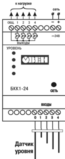
Рис. А.1. Схема подключения БКК1-24
