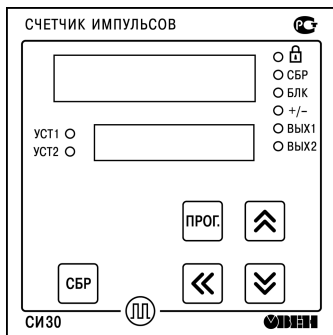
Рисунок 3.3 – Внешний вид лицевой панели прибора для корпусов настенного (Н) и щитового (Щ1) креплений
