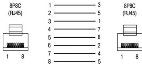
Рисунок В.7 – Кабель Ethernet crossover
