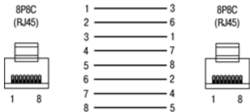
Рисунок В.7 – Кабель Ethernet crossover
