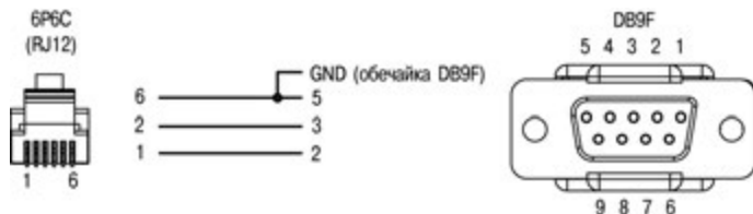
Рисунок В.5 – Кабель KC2 для подключения ПЛК100 к панелям ИП320, СП270 и СП3хх (порт RS-232 Debug)
