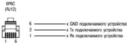
Рисунок В.4 - Схема кабеля для подключения к порту Debug RS-232
