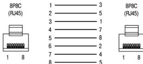
Рисунок В.7 – Кабель Ethernet crossover
