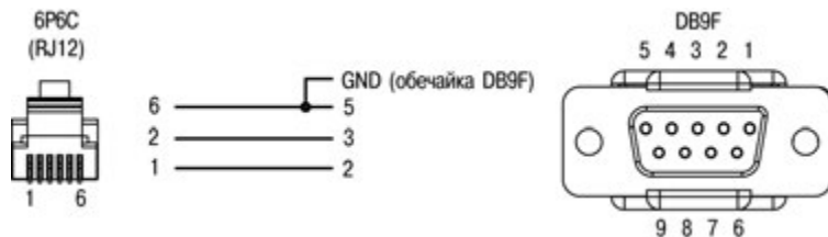
Рисунок Г.2 – Схема кабеля КС2
